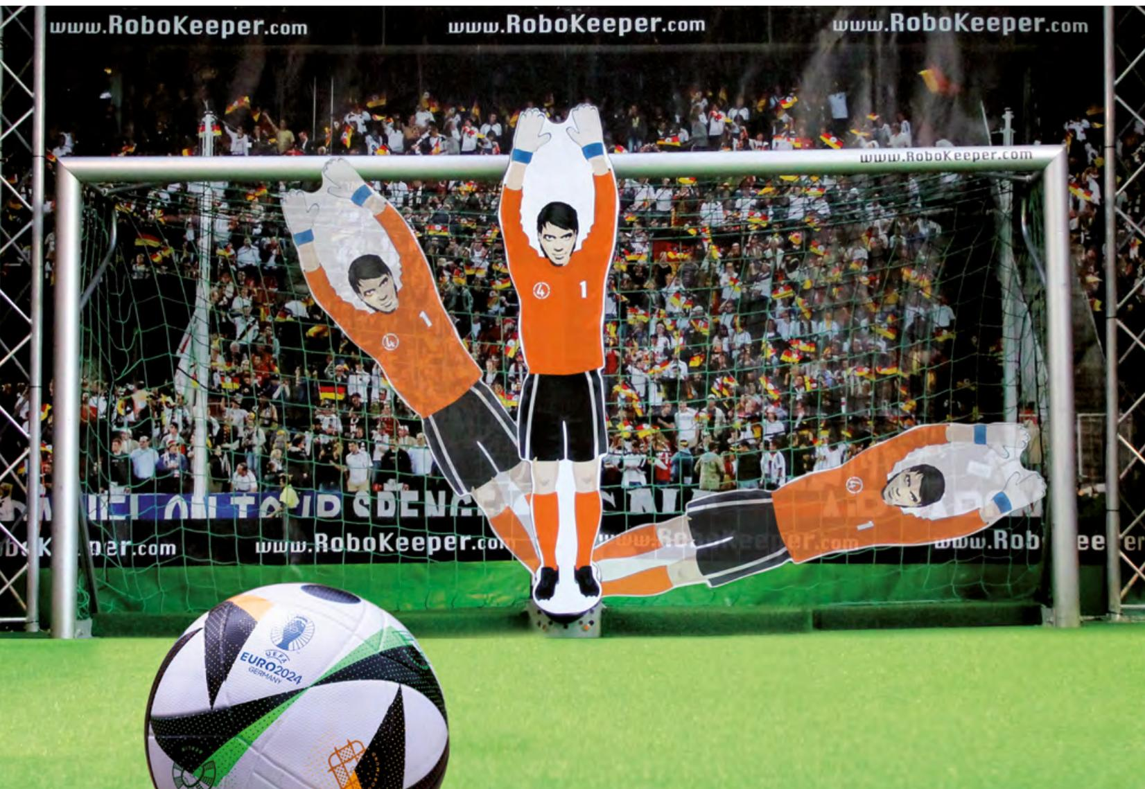
**G**egen ihn hatten selbst Spieler-Legenden wie Lionel Messi oder Neymar keine Chance: Der RoboKeeper aus dem Fraunhofer-Institut für Materialfluss und Logistik IML hält mithilfe von 3D-Bildverarbeitung, Steuer-Regel-Technik und Algorithmik nahezu jeden Ball. Entwickelt wurde der lebensgroße Tipp-Kick-Fußballer während der WM 2006 in Deutschland. Seitdem war er weltweit auf zahlreichen Events im Einsatz und wird ständig optimiert. Pünktlich zur EM 2024 erschien die neueste Version.
