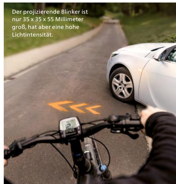
Der projizierende Blinker ist nur 35 x 35 x 55 Millimeter groß, hat aber eine hohe Lichtintensität.
