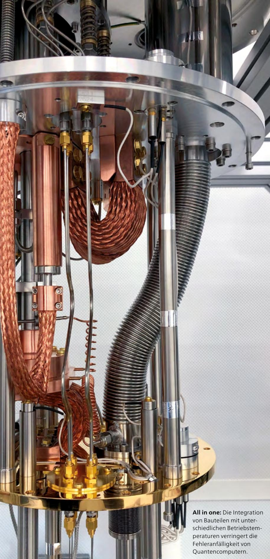
**All in one:** Die Integration von Bauteilen mit unterschiedlichen Betriebstemperaturen verringert die Fehleranfälligkeit von Quantencomputern.
